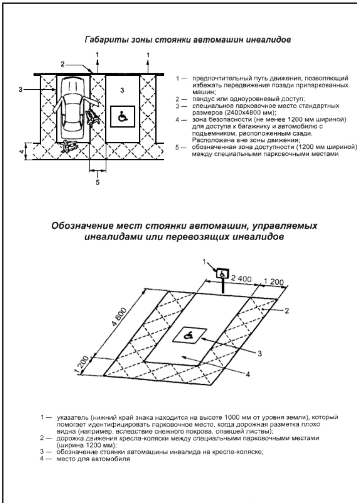
Рисунок Д.5 - Пути движения у здания
